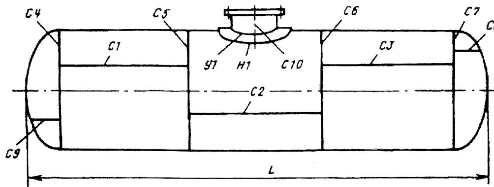
Примечание. Все участки сварных швов, подвергаемых контролю, в том числе места пересечения швов, должны быть обозначены на схеме.
